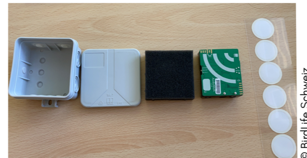
AudioMoth-Baukasten, damit der Audiologger wasserdicht eingepackt ist: Verbindungsdose, Rasterschaumstoff, Audiologger und Audiomembrane v.l.n.r.
